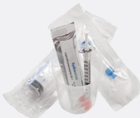
*Il kit tampone Hydrosense Legionella Field Test™ utilizza un test immunocromatografico per rilevare la presenza di antigeni di superficie cellulare dai batteri della legionella in un campione. La presenza dell'antigene fa sì che la "linea di prova" diventi rossa. È inclusa una "linea di controllo" che diventerà sempre rossa se il test è stato eseguito correttamente*
